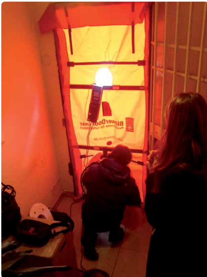
El nivel de estanqueidad que ha determinado el test es de Bajo, con un valor de 5,1 renovaciones/hora.
